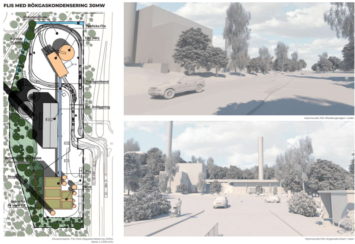
Figur 6. Utformningsalternativ 1, Flis med rökgaskondensering 30 MW, (ALStudio 2025).
